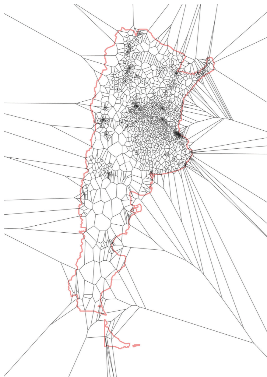
Figura 4 Celdas de Voronoi calculadas en torno a las antenas en el territorio argentino, indicando su área de cobertura.
